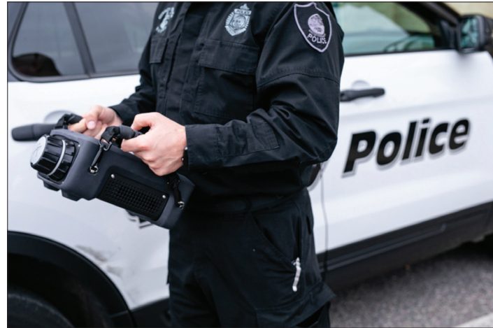
Một sĩ quan vận hành thiết bị đo phổ khối cầm tay với khả năng phân tích dấu vết trực tiếp tại hiện trường.
